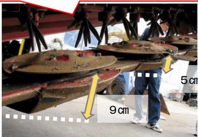
図3 モコンディショナ:通常の部品(右)とオプションのソリ(左)を装着したものの高さを比較
