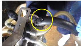
写真2 ミルクチューブの破損
