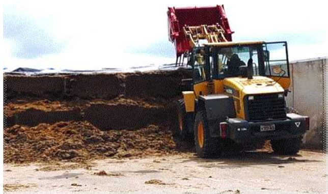
写真6 サイレージグラブ使用
